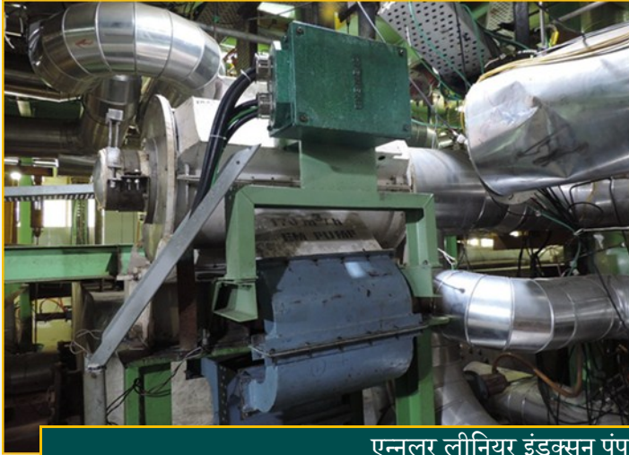
एन्नुलर लीनियर इंडक्सन पंप (ALIP) एवं त्रि-विमीय चित्र
