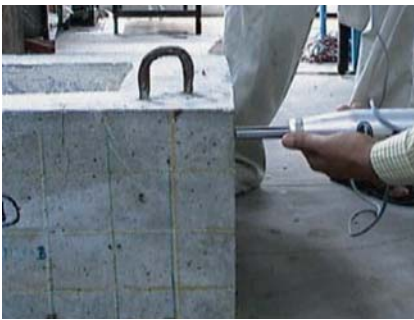
Fig. 3. Schmidt Hammer Test
