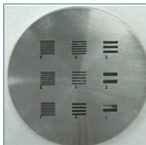
Fig. 2 Slit phantom
